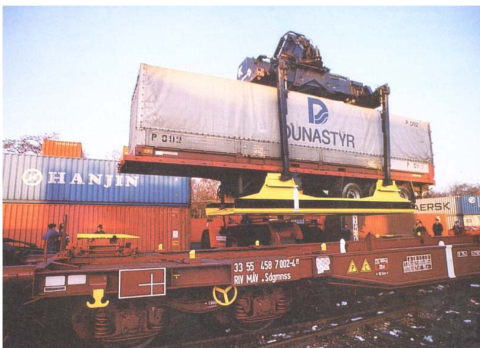
Рисунок 9. Погрузка полуприцепа по технологии «ЛО-ЛО»
