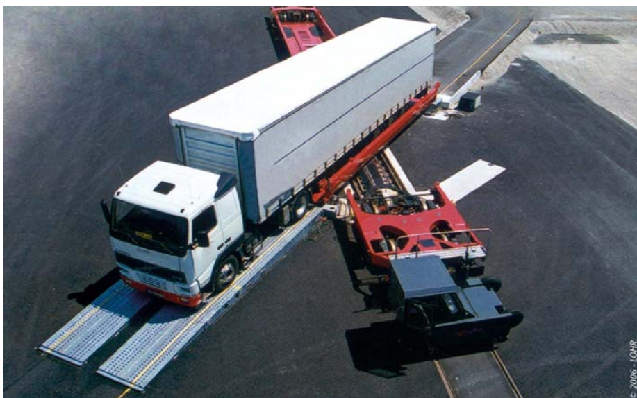
Рисунок 8. Погрузка полуприцепа по технологии «РО-РО» на специальные поворотные железнодорожные платформы.
