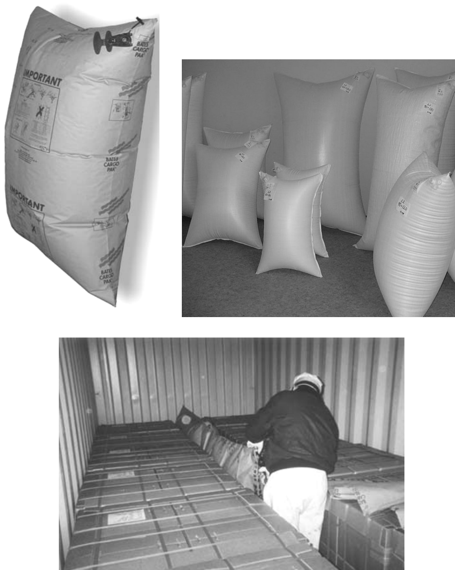
Рис. 3. Внешний вид пневмооболочек и использование их для крепления транспортных пакетов внутри контейнеров
