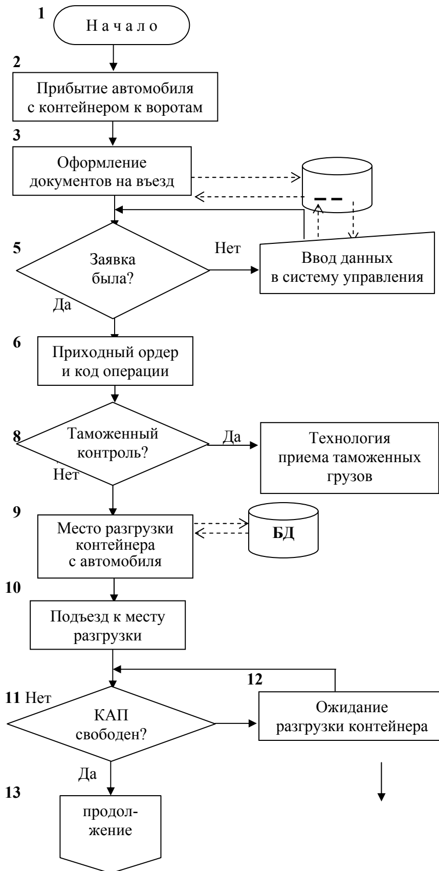
Рис. 3.2. Блок-схема алгоритма приема контейнеров с автотранспорта (операторы 1–12)
